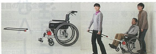
上:システムフレンドのブース 下2点:人力車のように扱える補助装置「Jinriki」
